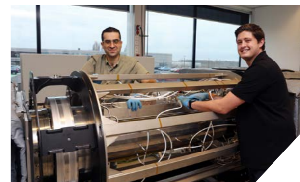
Kalpana, scale-up in Delft / Machines die snel en schoon dunne lagen kunnen aanbrengen op die batterijen en zonnecellen beter laten werken of een langere levensduur geven.
